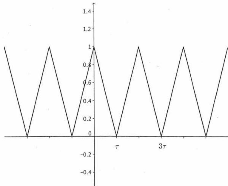
Ce signal est placé en entrée d'un filtre passe-bas (il s'agit d'un filtre de Butterworth d'ordre 6 et de fréquence de coupure 40 Hz).
